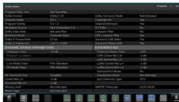
Dolby E メタデータがデコードされると、メタデータの開始点となる Dolby E Frame Location (ガードバンド) がディスプレイ内に表示されます。メタデータには、信号の Dialnorm、Dynamic Range、Downmix のパラメータが表示されます。
