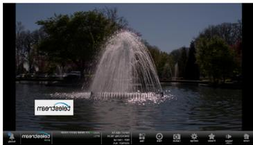
現在選択されている入力信号をフルスクリーンで表示します。この例はカメラの RAW 映像なので、低コントラスト、低彩度に見えます。
