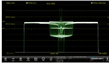
入力のガンマカーブを HLG (Hybrid Log Gamma) に設定し、テストシーンの反射率 90% の白と 18% のグレーレベルが適切なレベルになるように入力を調整しています。
