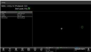
タイミング表示の四角形ウィンドウは、ビデオフレームを表しています。十字線はタイミングセンターを示し、円は基準に対する入力信号のオフセットタイミングを示します。基準はブラックバースト、3 値シンク、PTP から選択できます。
