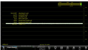
テスト信号源から 3G SDI 信号が PRISM に入力され、その結果、2 ライン掃引のジッタ波形が表示されています。10Hz タイミング・フィルタを適用し、自動的に P-P のジッタの結果を示しています。
