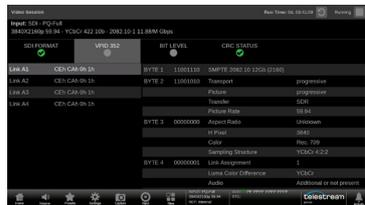
VPID 352 タブでは、トランスポート、ピクチャーレート、アスペクト比、カラー、サンプリング構造、ビット深度などの信号のフォーマットの解釈を行います。
