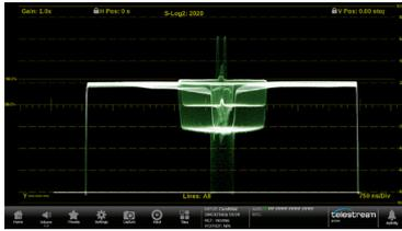
Stop 表示は、設定されている入力ガンマ変換関数に基づいた対数スケールです。この例では、ガンマカーブとして S Log 2 が設定されており、反射率 90% の白と 18% のグレーのレベルがスケール上で適切に設定されるように、カメラ出力が調整されています。
