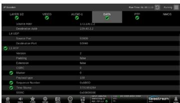
Dataタブには、IPアドレス、ポート番号、RTP レイヤー 5 の情報 (Marker、Payload Type、Sequence Number、Timestamp) が表示されます。
