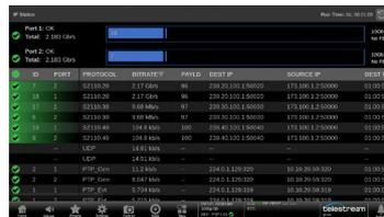
IP Status は、プロトコル、ビットレート、ペイロードタイプ、IP アドレス、MAC アドレスの情報を表示します。
