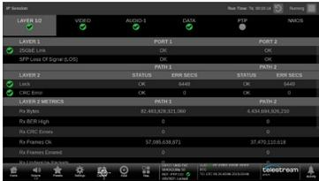
レイヤ1とレイヤ2のリンクステータスとともに、レイヤ2のメトリクス（受信バイト数、CRCエラー、フレームエラー、アンダーサイズパケット）を表示します。
