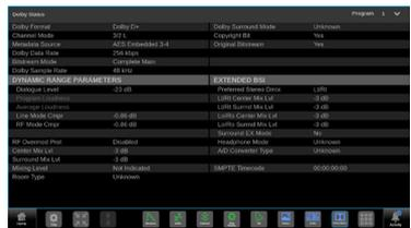
Dolby Digital または Digital Plus がデコードされると、データレート、チャンネル、ビットストリームモードの情報が表示されます。また、Dialogue Level、Dynamic Range、Downmix などのメタデータも表示されます。
