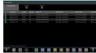
IP ゼネレータのディスプレイは、Transport、Video、Audio の設定状態が表示されます。テスト信号の詳細は、水平方向にスクロールして確認できます。
