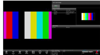
信号発生器のモーションを有効にすると、テストパターンが水平方向にスクロールして表示され、デバイスが正しく信号を処理しているかどうかを確認できます。
