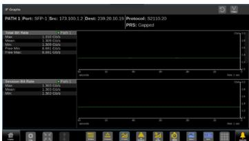
Total Bit Rate と Session Bit Rate は、Prism の SFP ポートに存在するストリームの総ビットレートを表示し、デコードしたストリームのビットレートを最大 24 時間表示できます。
