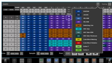
データリスト画面で ? マークを選択すると、特定の種類のデータを識別するためのカラー・コードの凡例が表示されます。例えば、スイッチング・ラインは茶色で表示されます。
