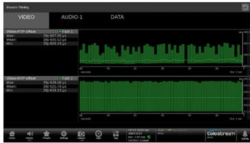
Video タブは、タイミング表示での変動量をプロットしてグラフ化した「Video-PTP offset」を表示します。Video-RTP offset は、埋め込まれた RTP タイムスタンプに対する受信した信号のタイミングが表示されます。
